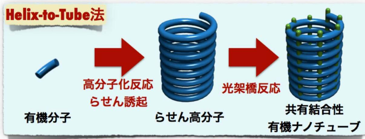
図3 本研究で開発した共有結合性有機ナノチューブの新合成手法「helix-to-tube 法」の概要。有機分子の重合によって高分子を合成するとともに自発的ならせん形成を行い、光架橋反応によってらせん高分子鎖間を共有結合で架橋する
