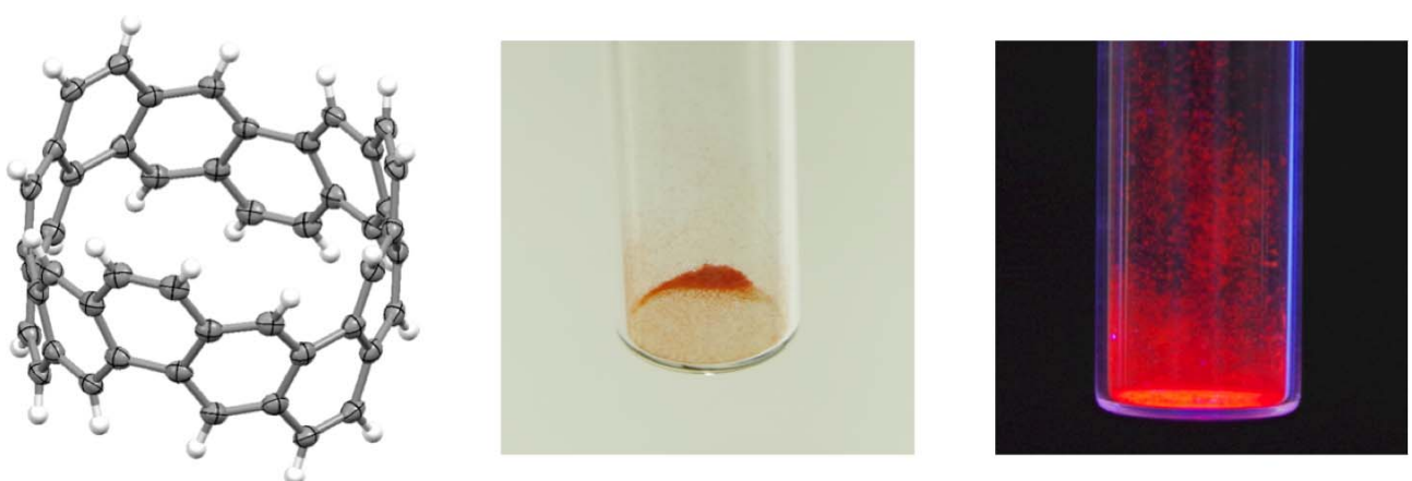
図6 「カーボンナノベルト」の構造解析図(左)と合成した「カーボンナノベルト」の固体(中央)とその蛍光発光(右)
